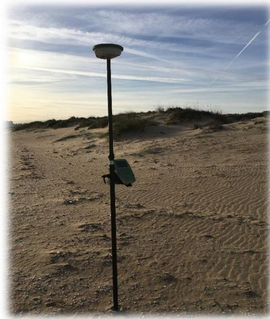
**Figura 2.** Equipo GPS RTK Leyca System 1200 en la zona de estudio.
