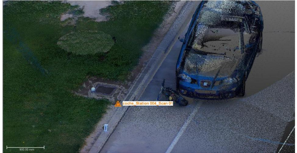
Ilustración 48: Resultado de la eliminación de ruido
