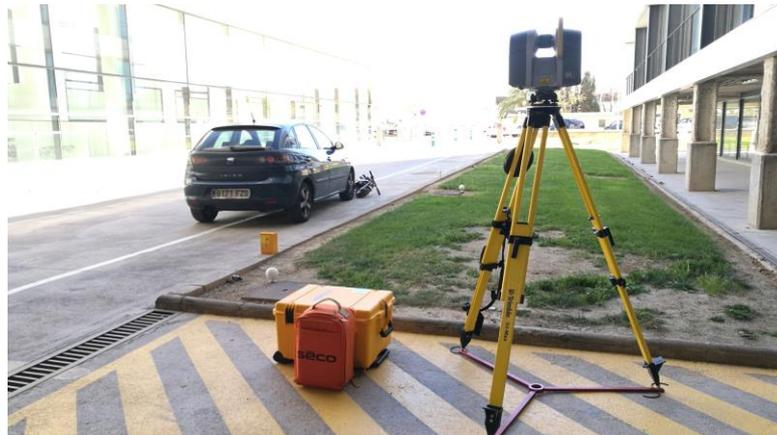
*Ilustración 11: Primer estacionamiento del láser escáner*
