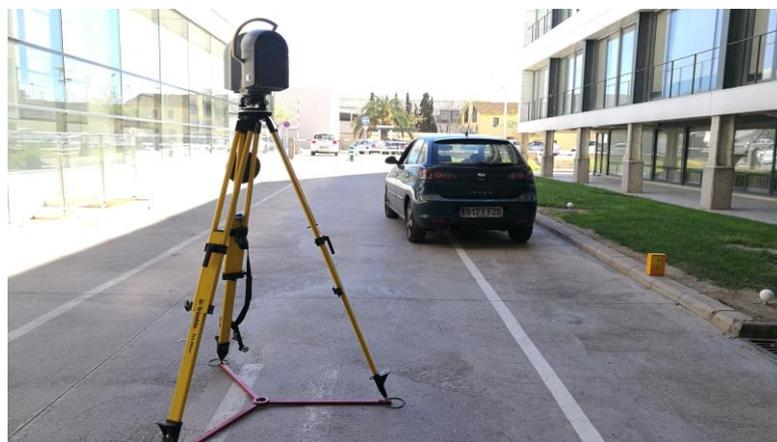
*Ilustración 12: Segundo estacionamiento del láser escáner*
