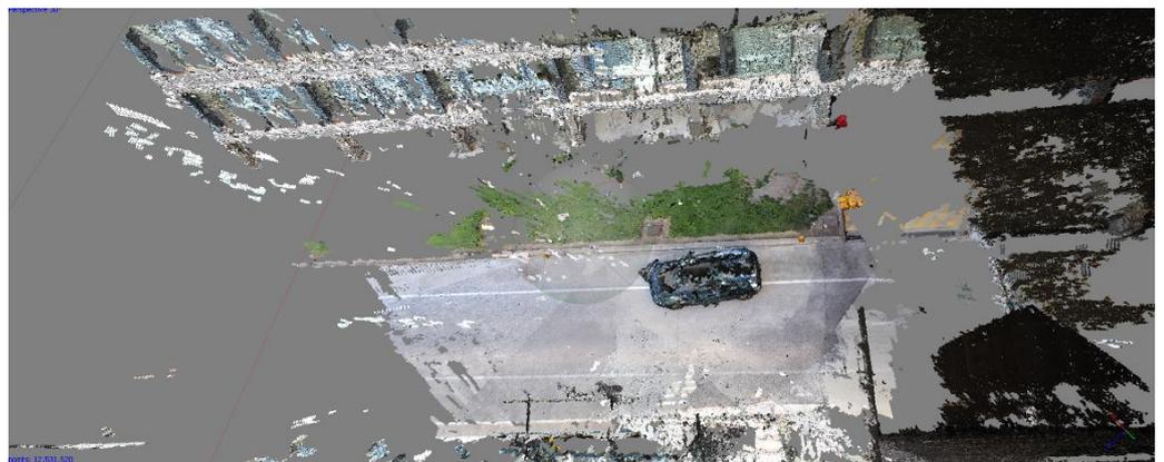
*Ilustración 17: La nube de puntos densa en PhotoScan*
