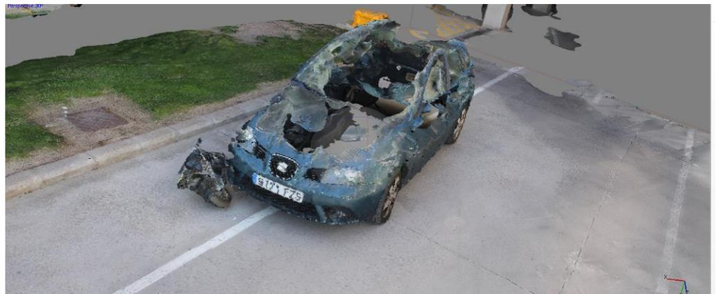
Ilustración 28: Resultado del mallado en 3DReshaper
